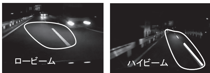
図4 前照灯ハイビーム視認距離はローの2.5倍: 照射白線数(ドラドラ画像、2014)
