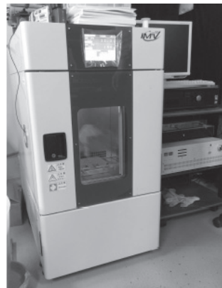
図13 温湿度・振動複合環境シミュレータ外観
