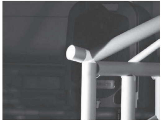
写真4 3Dプリンターによるジョイント部材
