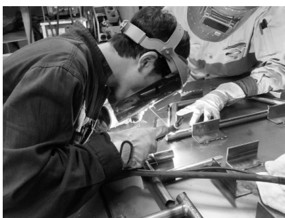
図16 フレーム製作の様子(溶接作業)
