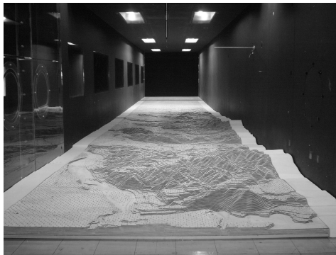
図7 地形模型設置状況（風下側より撮影）
