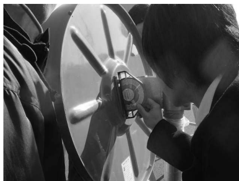
図6 ミラー背面に試験計を当てて俯角を測定する
