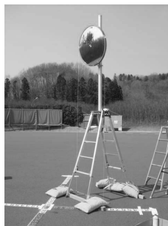
図5 水平角が調整できる実験用ミラー
