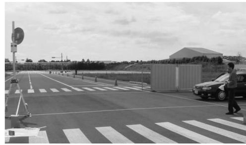
図2 ミラー視認性評価実証実験の実施状況 (JARI 実路テストコース)
