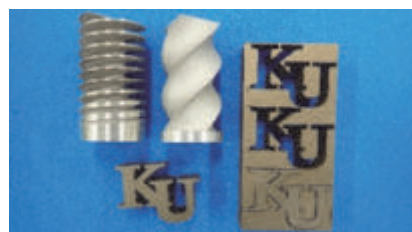
図 3 ワイヤ放電加工のサンプル(A5056,S50C)
