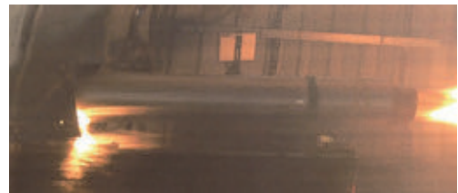
図1 燃焼中のエンジンから火炎が噴出している様子
