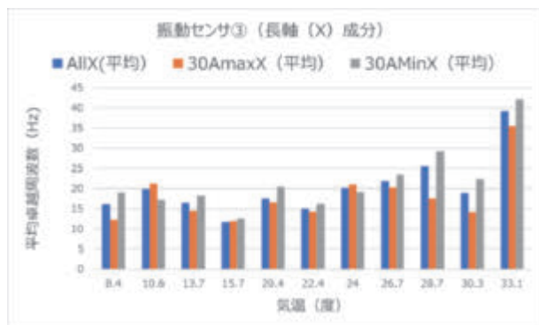
図 8 気温による平均卓越振動数の変化事例（振動センサ③）[3]
