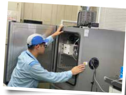
環境ガス計測器のセンサ出力特性を測定。
