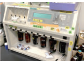
☆小野研の一押し装置1☆ DNA 合成装置。 この装置を使用することで、好きな核酸塩基配列の DNA を合成することができます。
