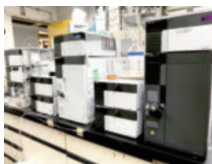
☆小野研の一押し装置2☆ 高速液体クロマトグラフィー (HPLC)。 DNA 合成装置で合成した塩基配列を、この装置を使用して分析する。
