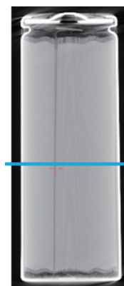
写真3 26650型円筒電池X線CT結果
